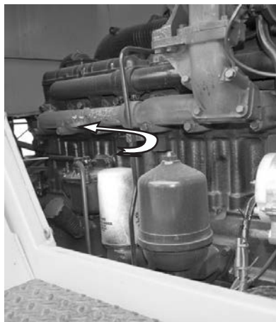
Рисунок 12 - Замена фильтра очистки масла
